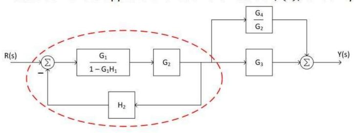
$$G_{eq}(s) = \frac{\frac{G_1 G_2}{1 - G_1 H_1}}{1 + \frac{G_1 G_2 H_2}{1 - G_1 H_1}} = \frac{G_1 G_2}{1 - G_1 H_1 + G_1 G_2 H_2}$$
